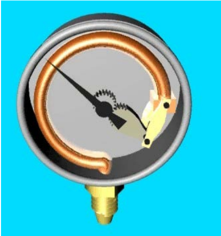
FIG. 2 PARTE INTERNA DI MANOMETRO A MOLLA TIPO "BURDON"
