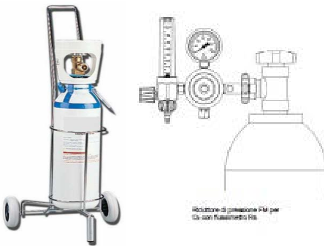
FIG. 22 BOMBOLA CON SOLA VALVOLA DI INTERCETTAZIONE DEL GAS E RIDUTTORE FLUSSIMETRO COLLEGATO
